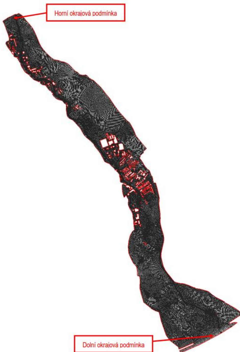
Obrázek 3 –Schéma výpočetní sítě modelu Odry
