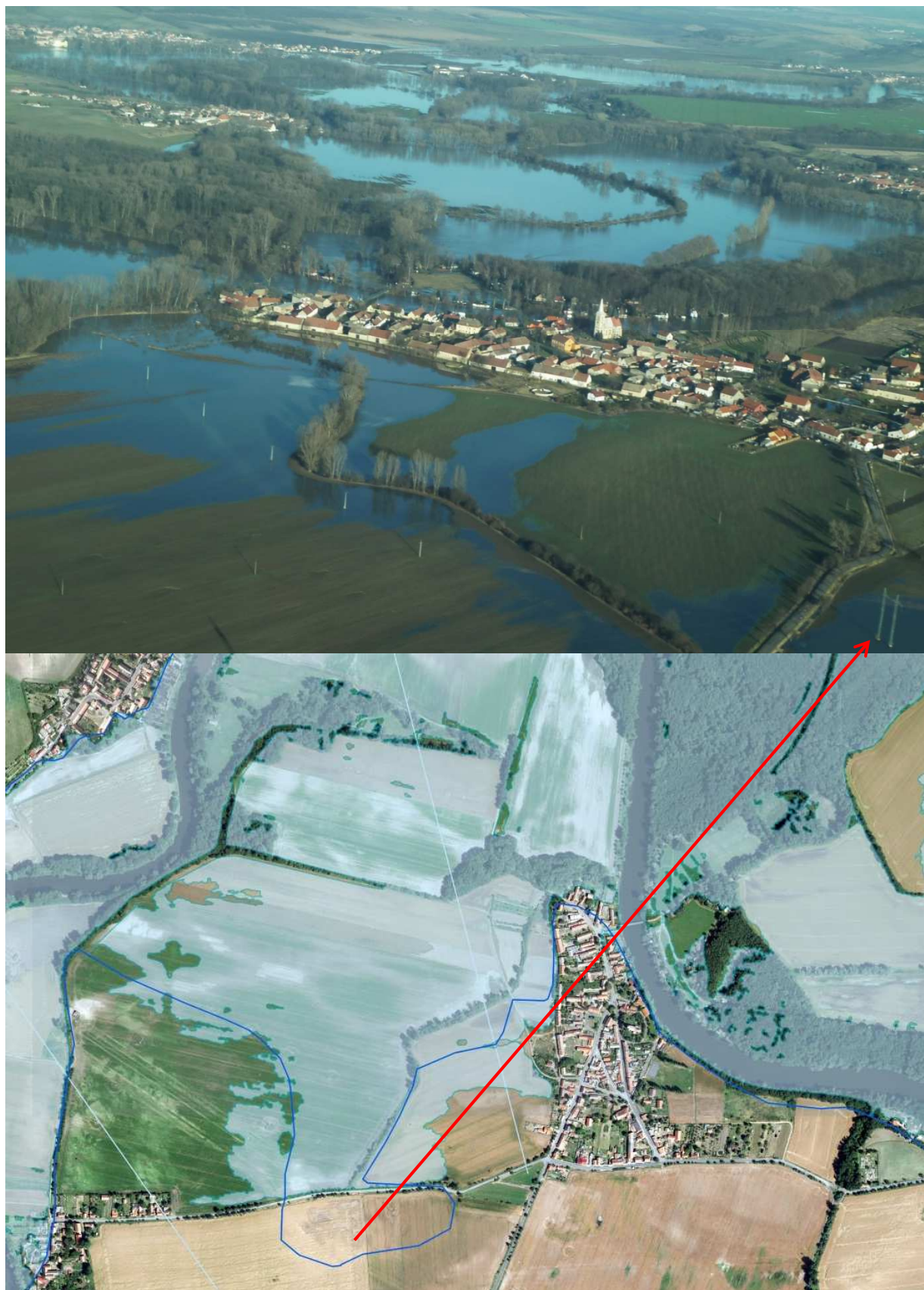
Obr. 5 – Porovnání výsledků kalibrace s leteckým snímkem pořízením v době kulminace povodně (Radonice n. O.)
