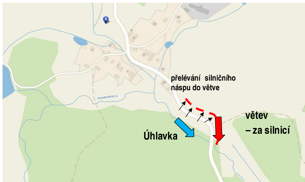
Obrázek – Situace schematizace modelu v místě větvení u silničního náspu
