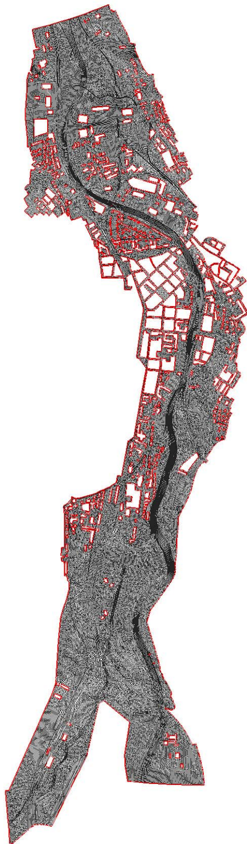
Obrázek 4 – Schéma výpočetní sítě modelu Tesin
