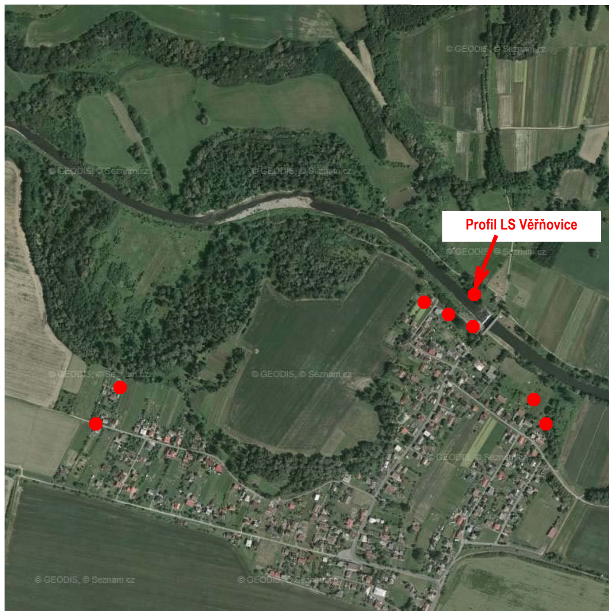
Obrázek 8 – Umístění zaměřených stop po kulminační hladině za povodně 2010 v okolí obce Věřňovice
