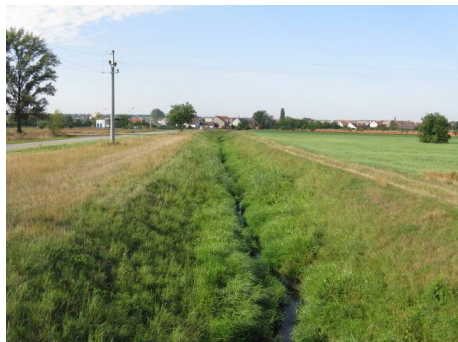
Obr. č. 3 Typické úseky pro rozdělení drsnosti: břehy holé, koryto zarostlé a zanešené - břehy holé, koryto zanešené, zástavba
