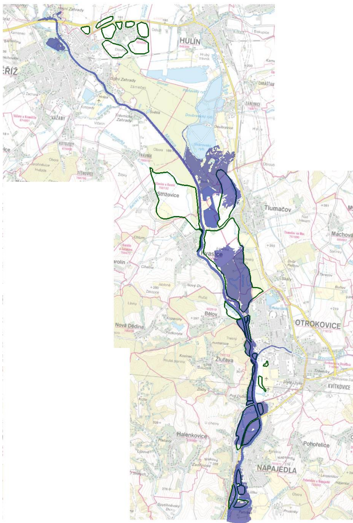
Obr. č. 7 Verifikace spřaženého 1D/2D modelu - část B pro povodeň 2010 – rozliv (modrá výplň značí výsledek výpočtů)
