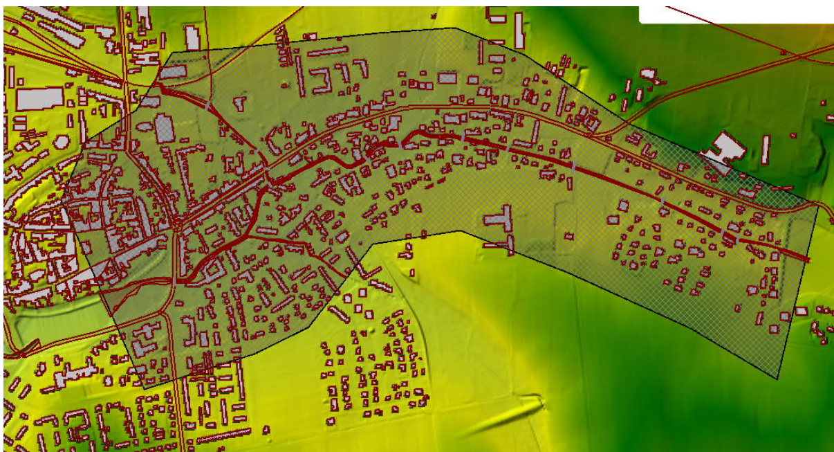
Obr. č. 19 Schéma výpočetní sítě pro střední úsek Bílého potoka DYJ_05-01 s přítokem od Cihelny DYJ_05-02 a Modřeckým potokem
