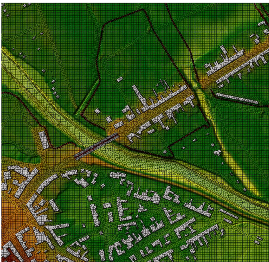
Obr. č. 9 Detail výpočetní sítě úseku DYJ_11-01
