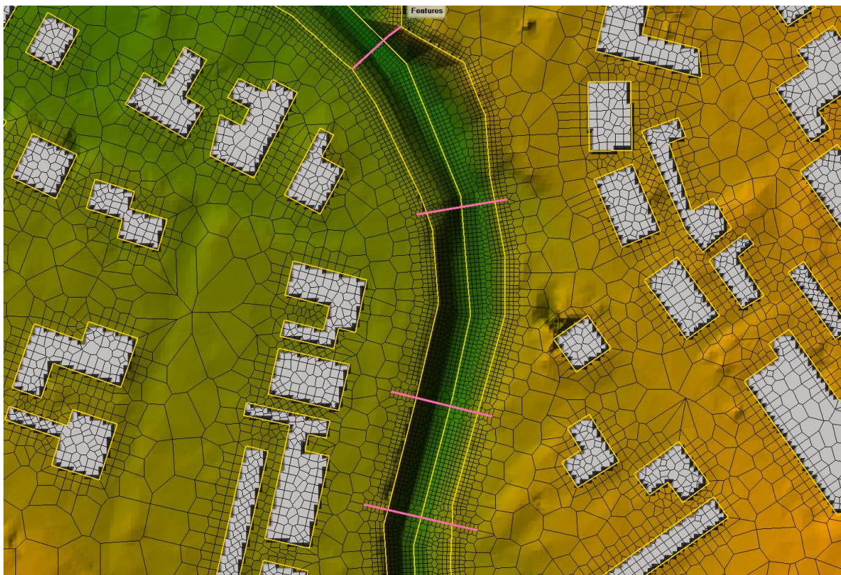
Obr. č. 6 Vybraný detail výpočetní sítě v rámci úseku MOV_13-01
