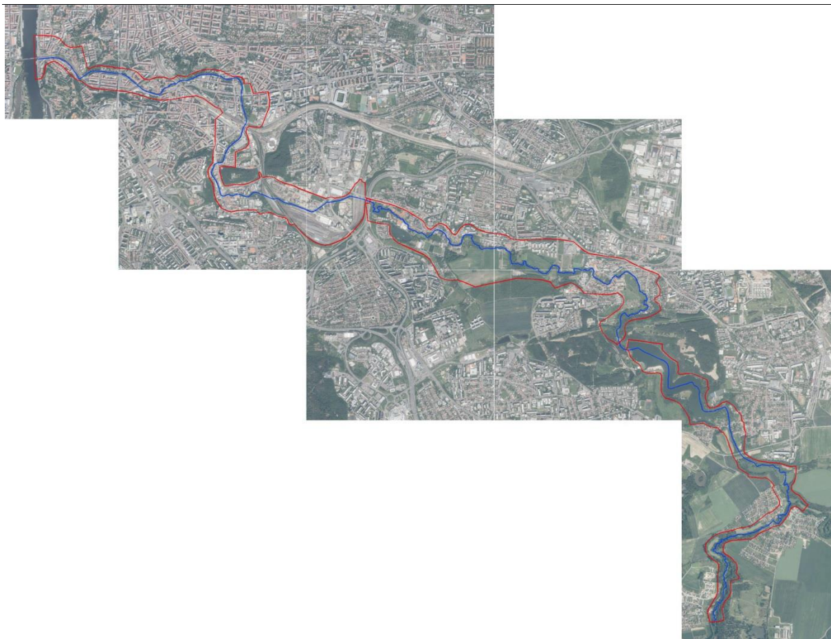
Obr. č. 2 Schéma na sebe navazujících 3 modelů záplavového území Botiče
