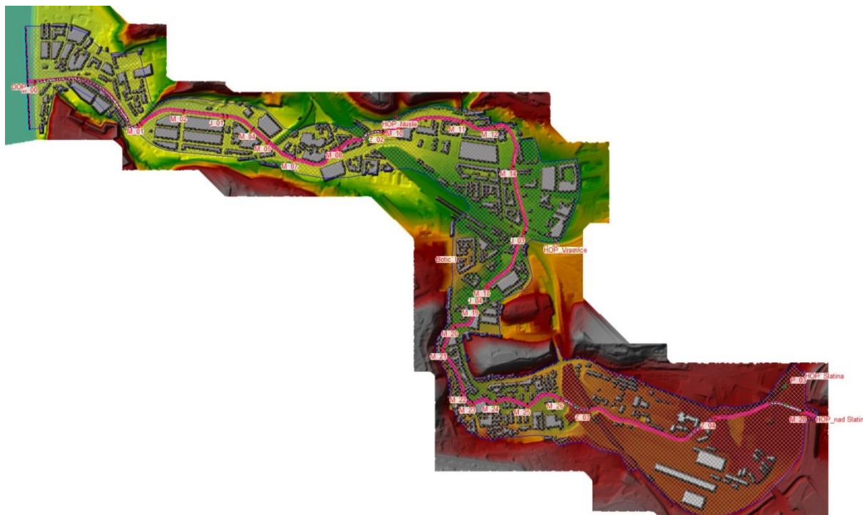
Obr. č. 3 Schéma výpočetní sítě Modelu 1 pro úsek od prvního Zakrytí u Záběhlic po ústí do Vltavy
